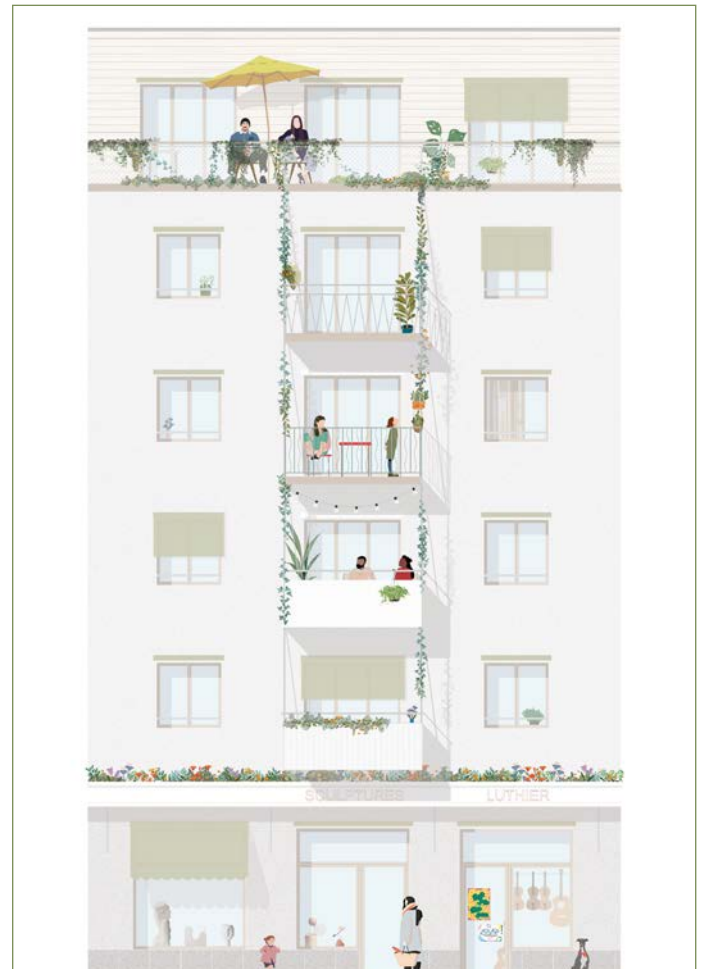
Die Fassade des Holzbaus an der General-Dufour-Strasse soll verputzt werden.
