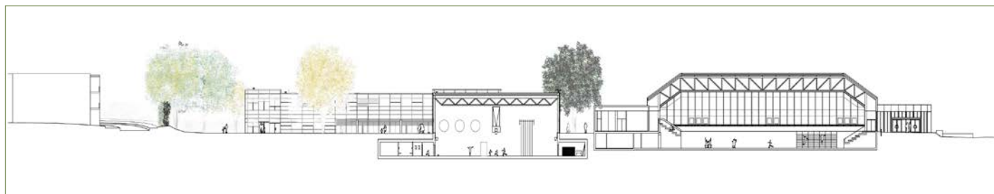
Wie die benachbarte Stadthalle ist auch die Turnhalle in den Boden eingelassen. Sie überragt das Schulhaus nicht.
